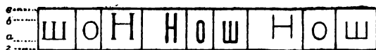
Фиг. 23. Линия шрифта в литерях разных рисунков: а — нижняя линия шрифта, б — верхняя линия шрифта, в и г — границы кегля
