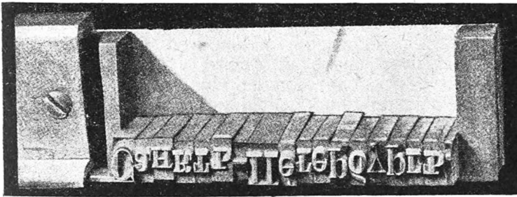
На рисунке литеры, не выравненные наборной линейкой, для наглядности показаны с большими выступами, чем это бывает в действительности.
