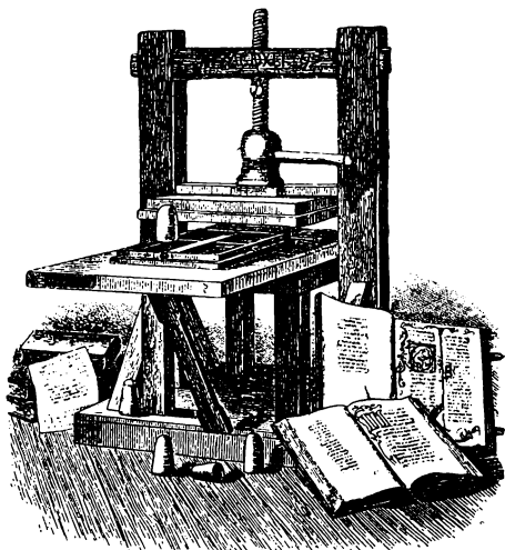
Станокъ Гуттенберга, возстановленный г. Клеммомъ изъ найденныхъ частей.
