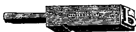
Въ такомъ видѣ отлитая литера выходитъ изъ ручной формы. Хвостъ на концѣ литеры называется гузкою.
